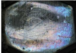
Fotoeffekt (Lichtoxidation): Die barocke Glasschmelze zur Herstellung der Scheiben und Gläser enthält immer noch verunreinigte Rohstoffe in Form von Metalloxiden. Unter Einwirkung des Lichtes (UV, elektromagnetische Wellen) können diese in einen höheren Zustand oxidieren (Eisenoxid  $F2O3$  = gelbliches Glas  $\rightarrow$   $F3O4$  = hellvioletter Tonwert, s. Foto 7).
